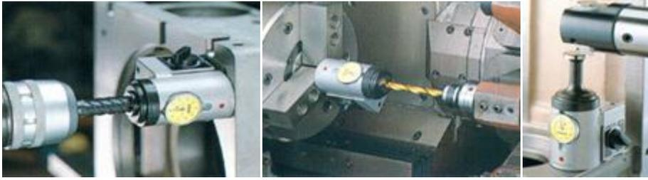
Рисунок 25 — Примеры использования Измерителя высоты.
