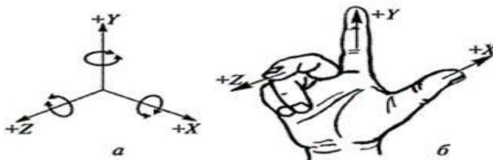
Рисунок 1 – Расположение осей координат на станках с ЧПУ (а); правосторонняя система координат (б)
